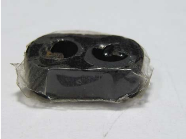
Núcleo recoberto por fita adesiva
